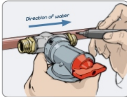
4. Mõõda täpselt ja eemalda see osa torust
